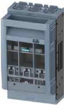
**SENTRON, fusible-interruptor-seccionador 3NP1, 3 polos, NH00, 160 A, para Montaje e instalación en placa de montaje, borne de caja, plano de cubierta 45 mm**
